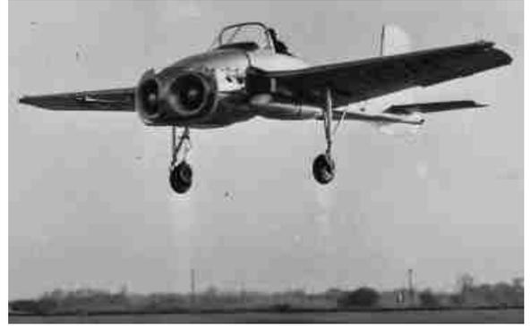
Ridesignato X-14B venne utilizzato fino a che non venne danneggiato irrimediabilmente in incidente in fase di atterraggio, il 29 maggio 1981, quando, a causa di un problema legato al sistema di controllo del pilotaggio automatico VSCAS (Variable Stability Control Augmentation System), il pilota collaudatore Ron Gerdes ne perse parzialmente il controllo.
